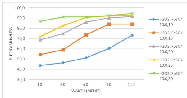
Grafik-3 Hubungan antara penyisihan kadar TSS (%) dengan waktu kontak (menit) rasio molar H 2 O 2 : FeSO 4
