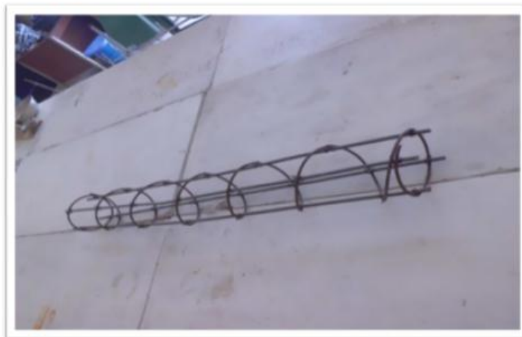
Gambar 5. Tulangan dengan sengkang spiral untuk kolom berongga 20/20
