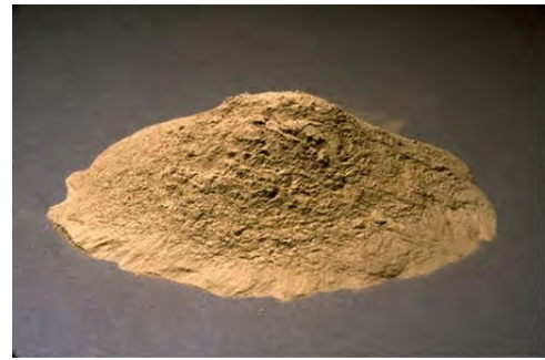
Gambar 1. Fly Ash yang Digunakan dalam Penelitian
