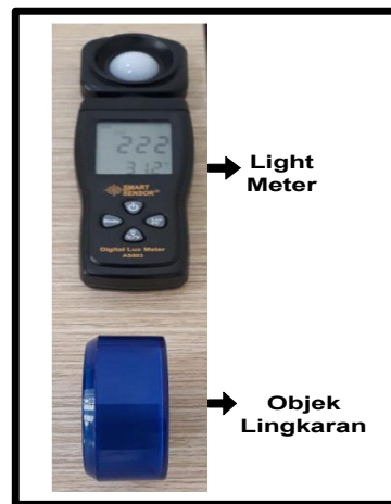
Gambar 5. Gambar Posisi Light Meter dan Objek Lingkaran pada Intensitas Cahaya 222 Lux
