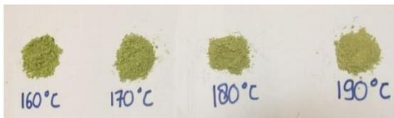
**Gambar 4. Ekstrak daun ashitaba bubuk berbagai variasi suhu udara inlet pengeringan**
