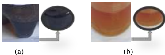
Gambar 5. Perbandingan Warna Asap Cair dari Biomassa Sabut Kelapa (a) Sebelum dan (b) Setelah Pemurnian
