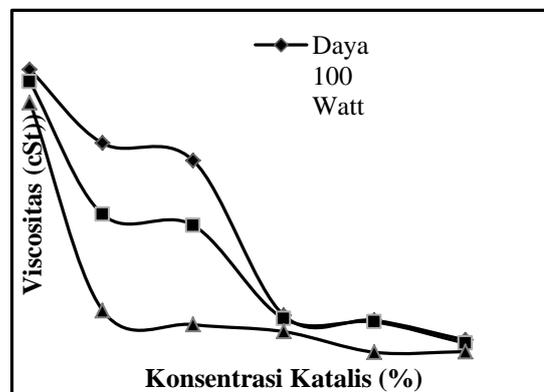
Gambar 2. Hubungan konsentrasi katalis KOH terhadap viskositas produk biodiesel pada berbagai variasi daya dengan waktu reaksi 150 detik
