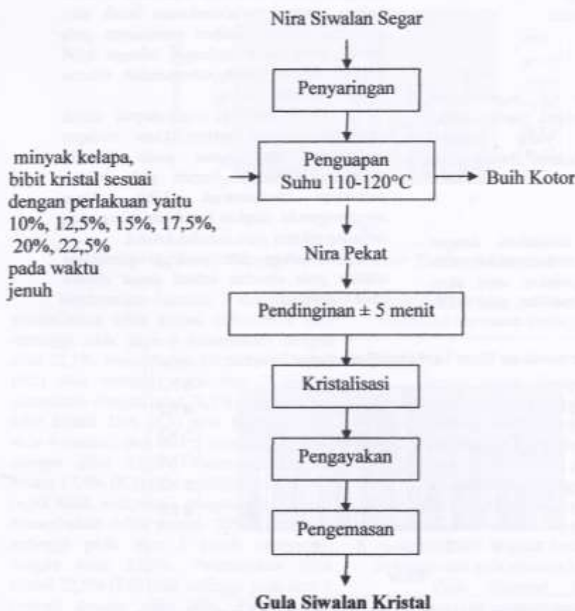
Gambar 1. Diagram Alir Proses Pembuatan Gula Siwalan Kristal
