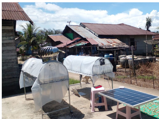
Gambar 1. Alat Pengering Sistem Turbin Ventilator dan Blower
